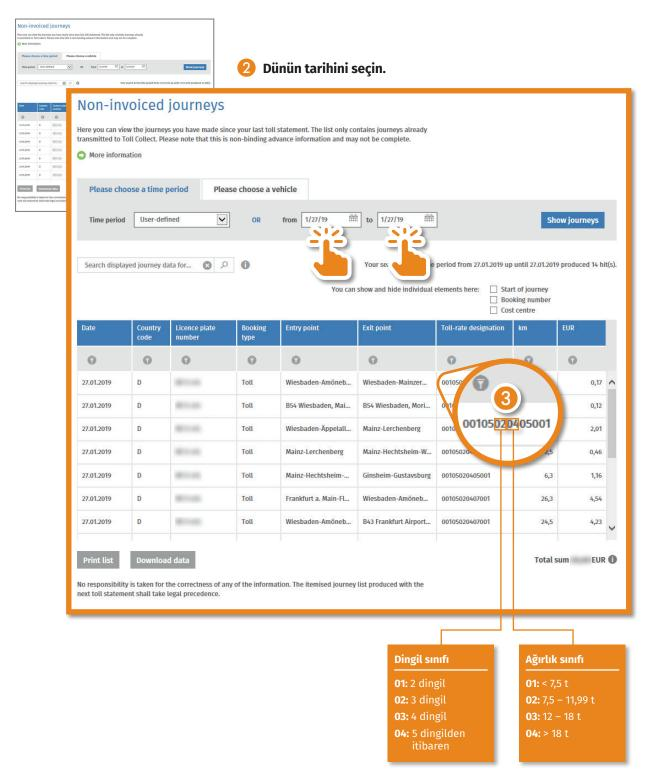
Sürücü, fiilen araç cihazı (OBU) üzerinde bu dingil ve ağırlık sınıfı ile seyir halindedir.
